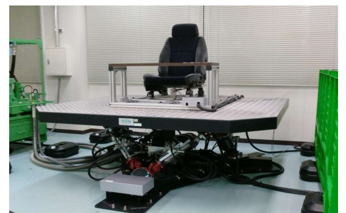
3次元6自由度加振装置によるドライビングシミュレータ
